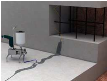
Инъектирование сухих трещин
