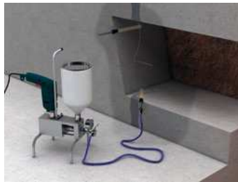
Инъектирование влажных трещин и трещин с активными протечками
